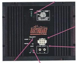
EASY SNAP ON/OFF MOLEX PLUG HOUSES THE CONNECTORS FOR POWER AND SPEAKER LEVEL INPUTS. IT MAKES THE AMPLIFIED ENCLOSURE USABLE IN DIFFERENT CARS.
